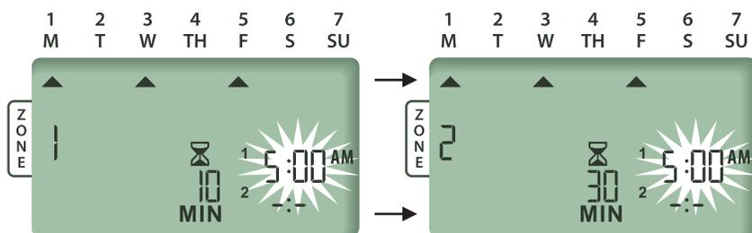
Моменты запуска автоматически упорядочиваются, что обеспечивает одновременный полив лишь одной зоны.
